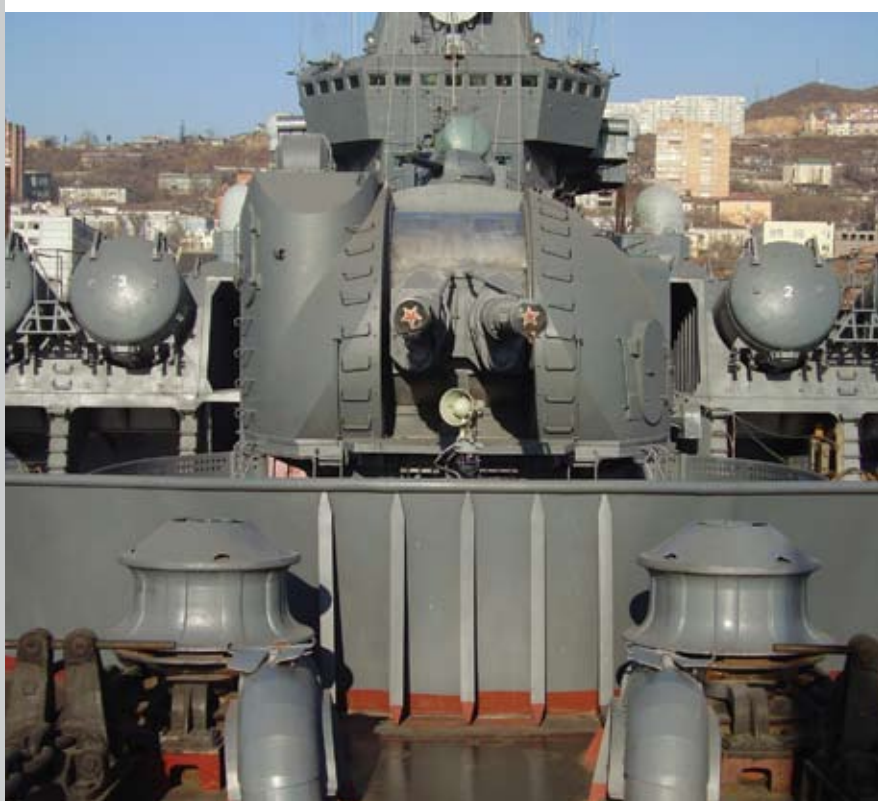
Ракетный крейсер «Варяг». Доковый кап.ремонт. Окраска надводного борта, надстроек и пр.: Гамма-АУР-067Т и Гамма-АУР-167.
