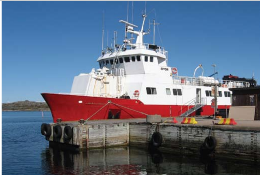
Грузо-пассажирское судно «Eivor». Надводный борт окрашен однокомпонентными алкидными материалами - грунтовка Темапрайм ЕЕ и финишная краска Темалак ФД 80.
