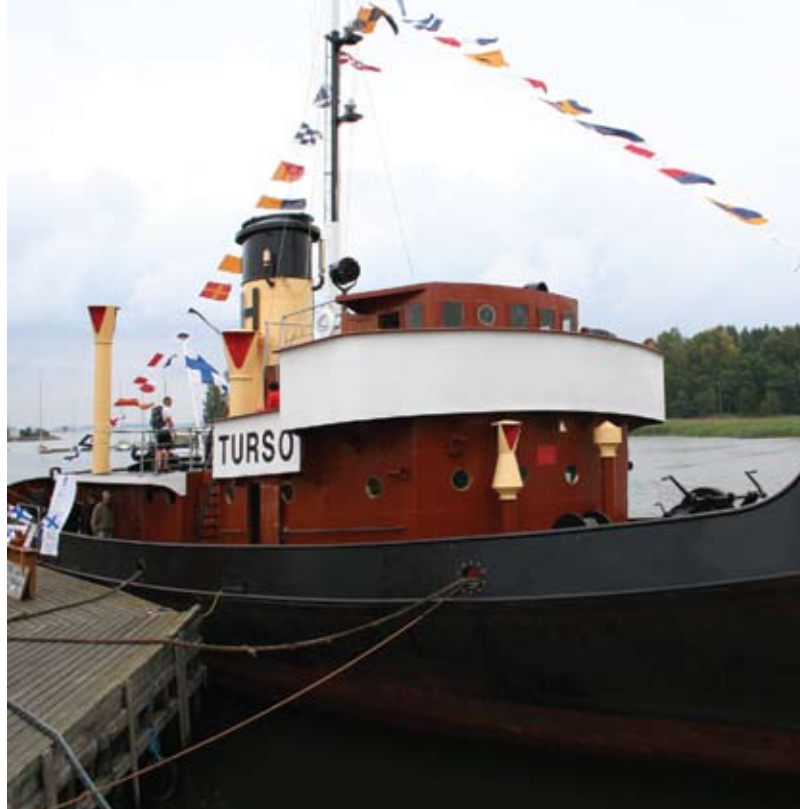
Портовый ледокол «Turso». Надводный борт окрашен однокомпонентными алкидными материалами: грунтовка Темапрайм ЕЕ и финишная краска Темалак ФД 50.
