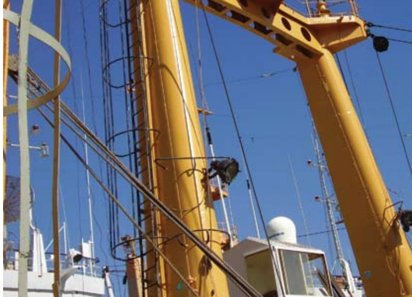
Траулер «Владивосток». Мачты и стрелы окрашены экипажем однокомпонентными алкидно-уретановыми и алкидными материалами Гамма-АУР-067Т и ПФ-167.
